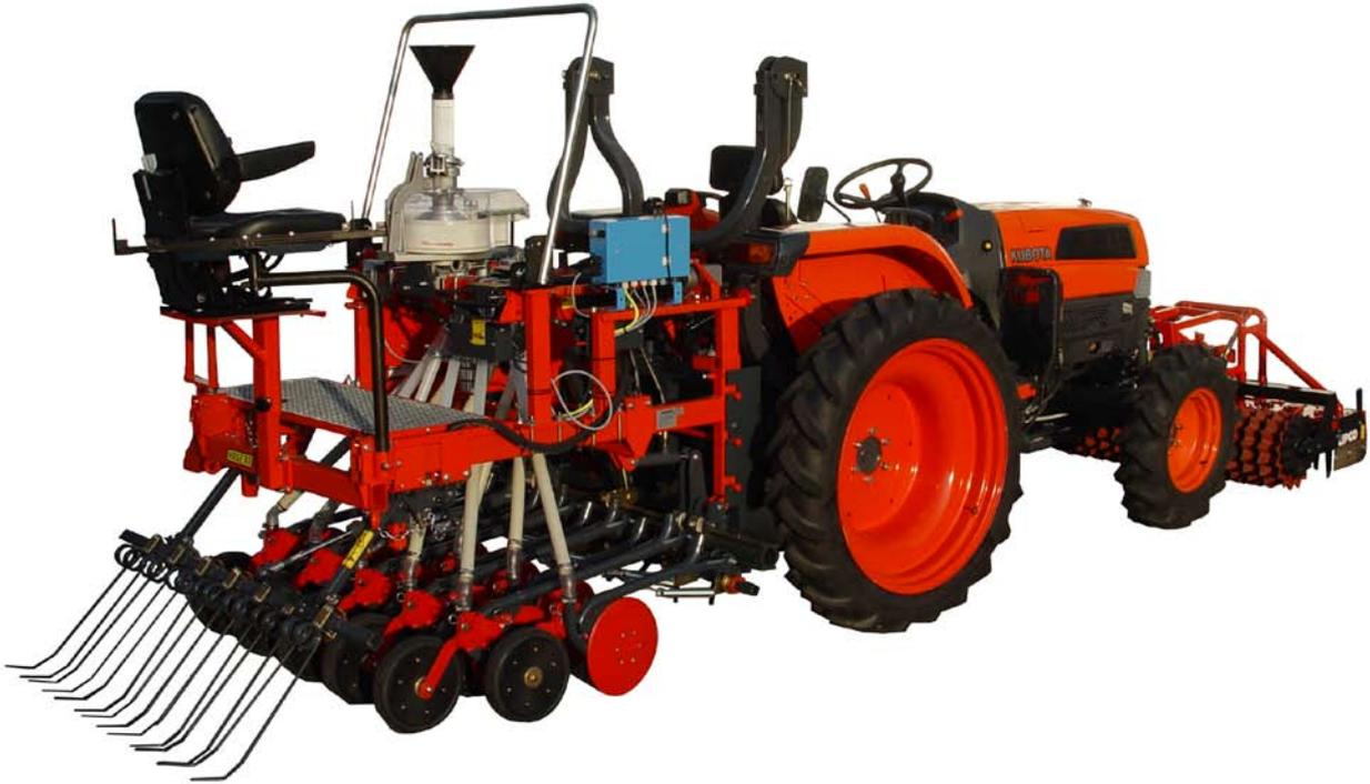
Parzellentraktor Kubota L5030 mit Kabine und Parzellen Einzelkornsämaschine Hege 95:
