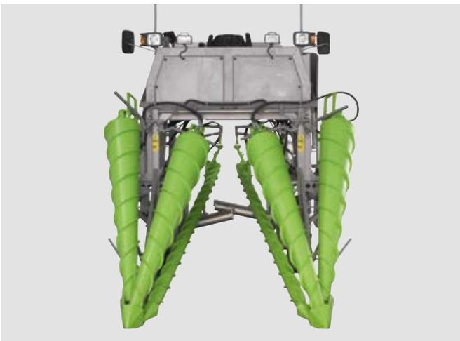
4 oben- und 2 untenliegende Torpedos sowie 2 horizontale Druckrollen
