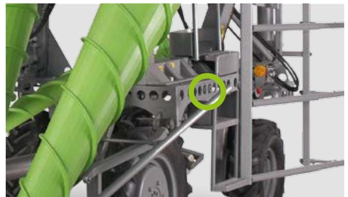
Stellschrauben für die Spurbreitenverstellung an der Vorderachse
