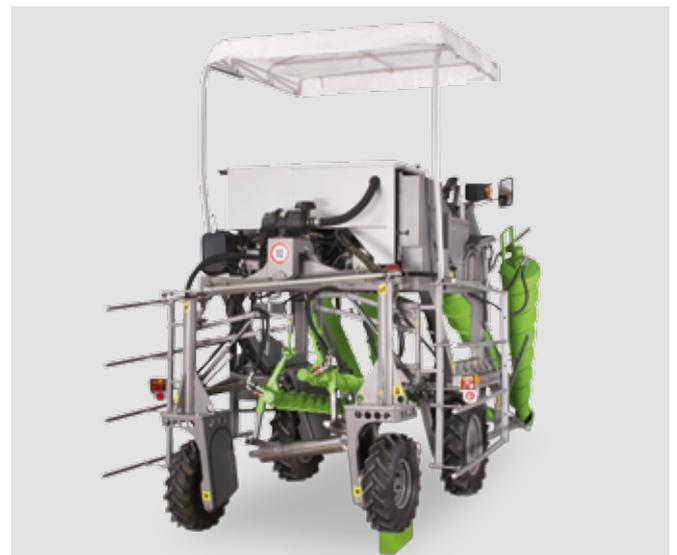
Pendelachse an der Hinterradaufhängung für hohe Anpassungsfähigkeit
