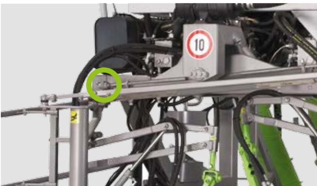
Stellschrauben für die Spurbreitenverstellung an der Hinterachse
