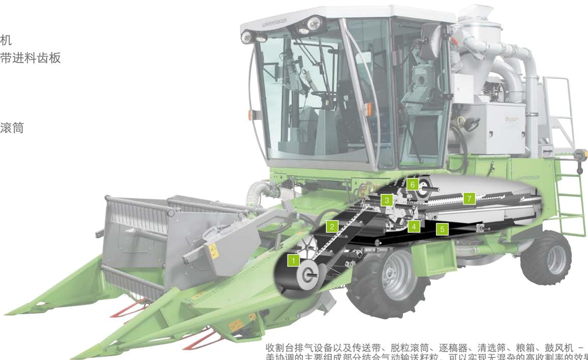
收割台排气设备以及传送带、脱粒滚筒、逐稿器、清选筛、粮箱、鼓风机 - 这些完美协调的主要组成部分结合气动输送籽粒，可以实现无混杂的高收率的效果
