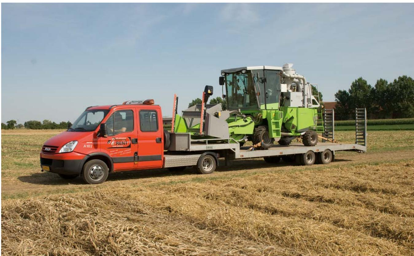
紧凑的结构设计, 可在不拆卸部件的情况下方便的进行运输 (最大运输高度: 2950 mm)
