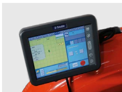
Montagem da tela de controle no trator
