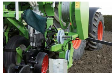
Comando a fune con avvolgitore per fune
