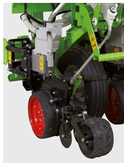
Realizzazione compatta della trasmissione elettrica nell'elemento di semina
