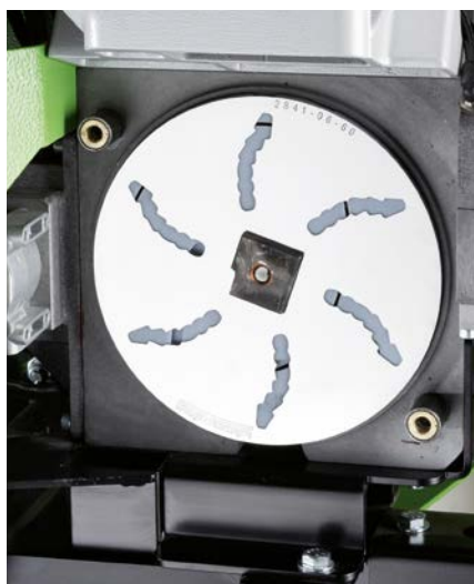
Disco ad intaglio radiale e disco retrostante ad intaglio a spirale
