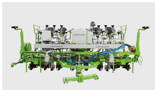
Dynamic Disc 8 file con telaio base versione pull type
