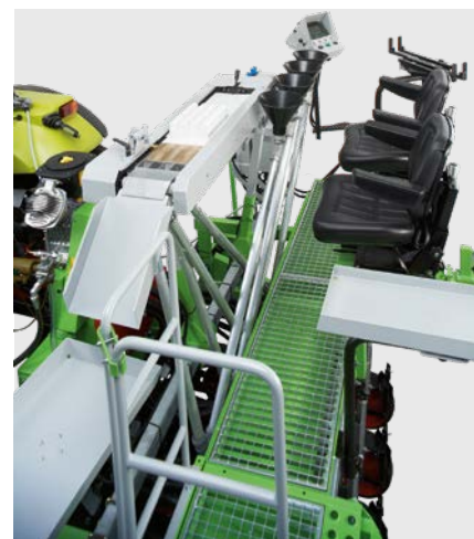
Caricamento a celle e tramoggia singola
