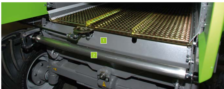
1 Réglage électrique de la grille à lamelles 2 Capteur de perte de grains
