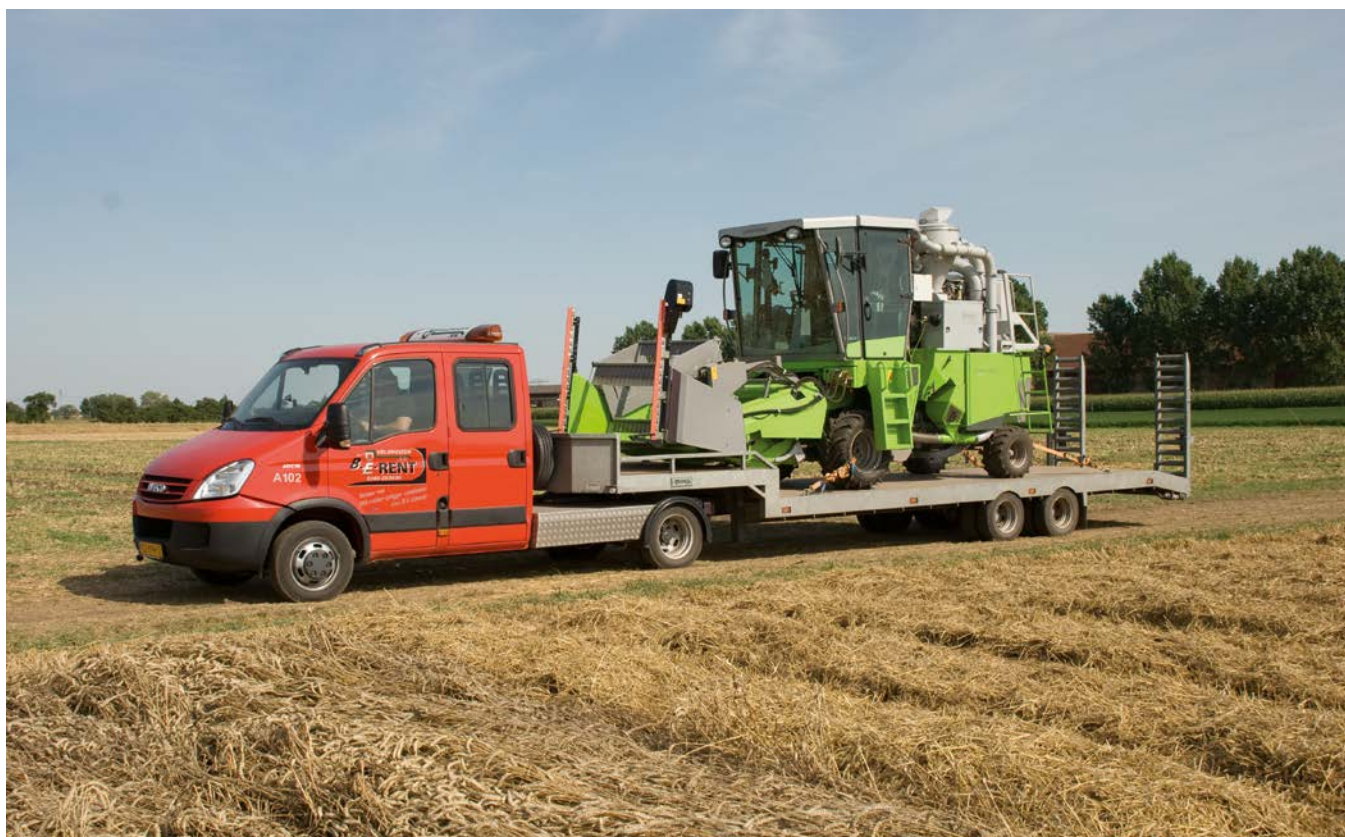
Le construction très compacte permet un transport sans démontage des composants (Hauteur de transport max. : 2950 mm)
