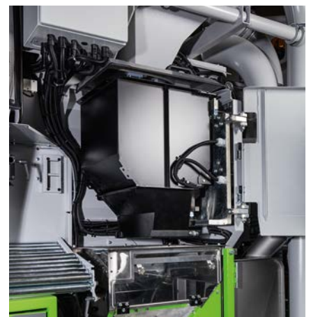
Bucketsystem (Behälterwiegesystem)
