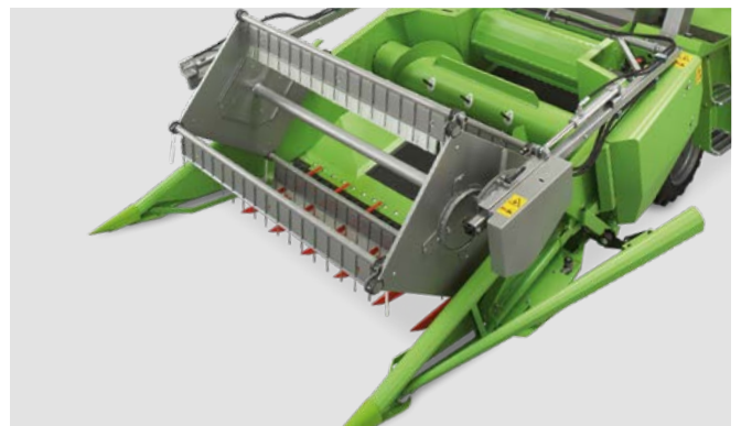
Schneidwerk mit Bandeinzug
