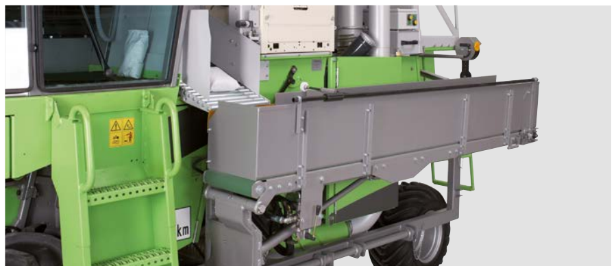
Probentransportband während der Befüllung
