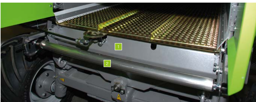
1 Elektrische Lamellensiebverstellung 2 Kornverlustsensor
