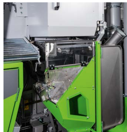
NIRS-Systemlösung zur Erntegutanalyse
