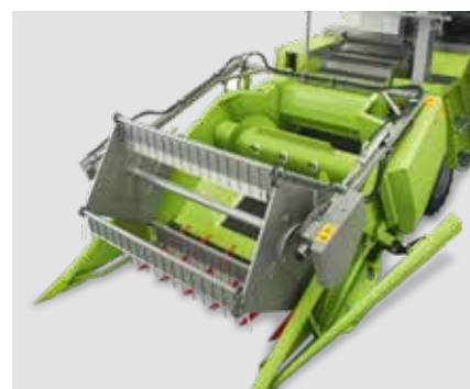
Mecanismo de corte con alimentador de cinta
