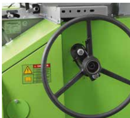
Variador del cilindro de trilla
