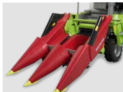
Módulo de arranque de maíz de 2 hileras
