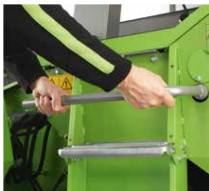
Dispositivo de rotación inversa del cilindro de trilla
