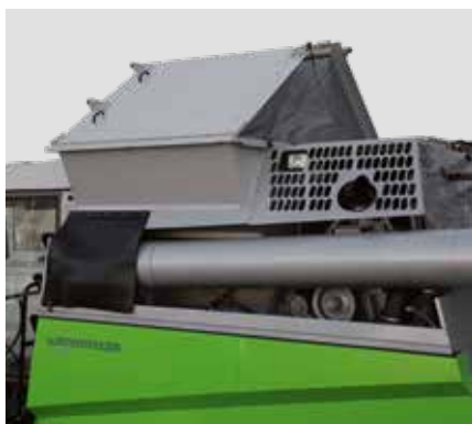
Ampliación del tanque de grano a 6200 l
