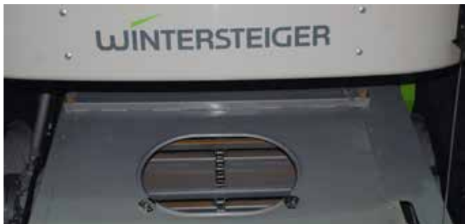
Abertura de limpieza canal de alimentación
