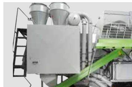
Transporte de grano doble neumático
