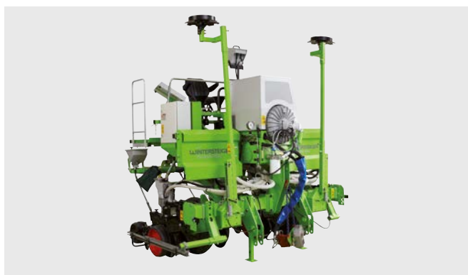
Dynamic Disc sobre bastidor básico de 4 filas en ejecución de 3 puntos
