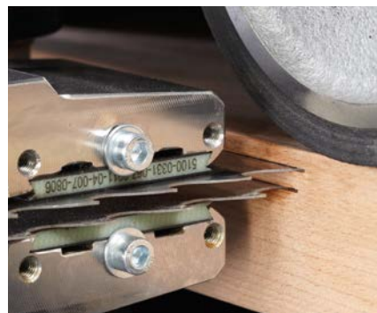
高科技碳枕式锯条导向设计极具抗磨损能力
