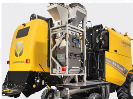
Высокоэффективная система взвешивания Twin H2 от HarvestMaster, обеспечивающая точные показатели массы, влажности и объемной массы
