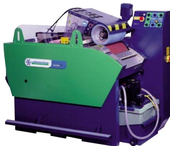
**Metà e metà.** Con la pietra di rettifica della Micro 71, di ampiezza pari a 350 mm, è possibile impiegare in un solo processo di rettifica tutte le importanti varianti strutturali. In base alle necessità, è possibile applicare con la stessa pietra due diverse impronte. In tal modo sarà quindi possibile eseguire ad esempio la rettifica dello sci con una metà della pietra e la microfinitura con l'altra metà, aumentando considerevolmente la vostra efficienza.
