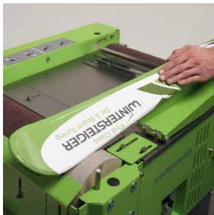
Die integrierte Kantenbrech-Scheibe garantiert einfaches und effektives Kantenbrechen von Ski und Snowboards.
