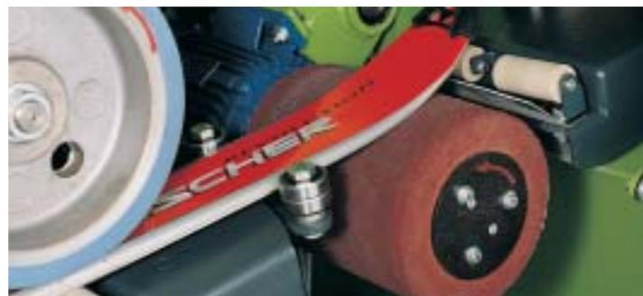
**Polieren.** Glänzend arbeitet auch die bewährte Scotchbrite-Walze, die für ein perfektes Ergebnis beim Polieren sorgt. Die **shuttle 3C** vollendet das erstklassige Skiservice mit dem Entgraten der Kanten und dem Polieren des Belages, wobei das Aggregat zwischen den Ski oszilliert.
