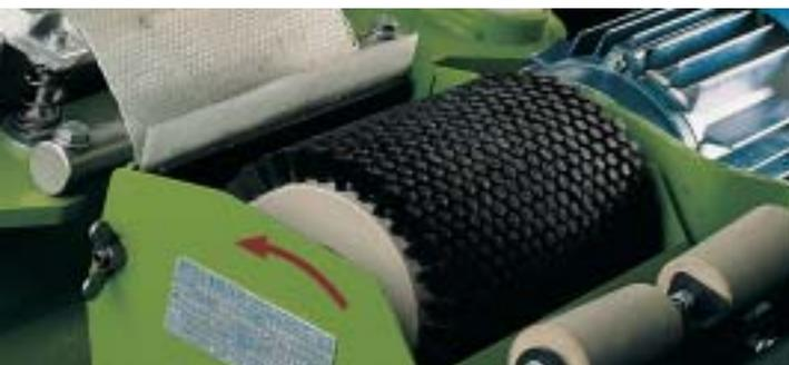
**Strukturbürsten.** Mit Hilfe der Strukturbürste wird überflüssiges Wachs entfernt und die Steinschliffstruktur freigelegt.
