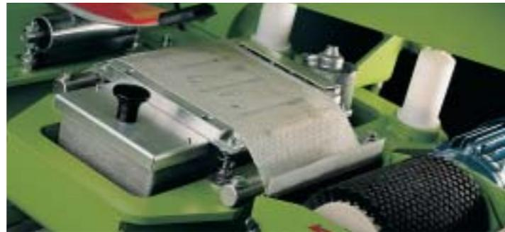
**Heißwachsen.** Durch das Vorwärmen des Skibelages wird eine bessere Wachsaufnahme ermöglicht, was die hohe Funktionalität des patentierten Vliesverfahrens bestätigt. Die ständige Bewegung des Wachsvlies gewährleistet einen konstanten und damit optimalen Wachsaufrag.
