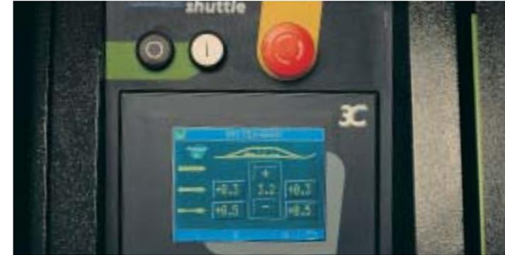
**Touch me!** Die Bedienung des **shuttle 3C** erfolgt über einen Farbmonitor mit Touchscreen-Technik. Der Bediener wird mittels leicht verständlichem Menü durch das Programm geführt. Vollständige Service-Abläufe, aber auch einzelne Servicekomponenten können hier gespeichert und jederzeit abgerufen werden. Die exakte Reproduktion spezifischer Schliff- und Belagstrukturen ist so durchführbar.
