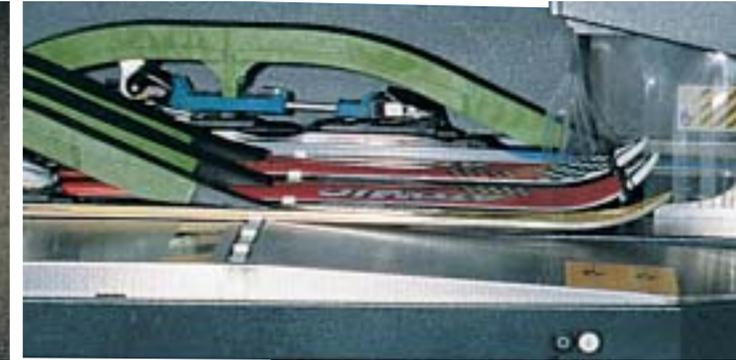
**Beschickung und Entnahme.** Die Beschickung der **shuttle 3C** erfolgt automatisch mit bis zu 6 Ski, wobei das Vorsortieren nach Skilängen und -breiten entfällt und alle Ski unabhängig von ihrer Oberfläche bearbeitet werden können. Über das Vorschubsystem werden die Ski selbstständig einmal oder mehrmals über die Schleifaggregate geführt und anschließend auf die Entnahmestation abgeleitet.
