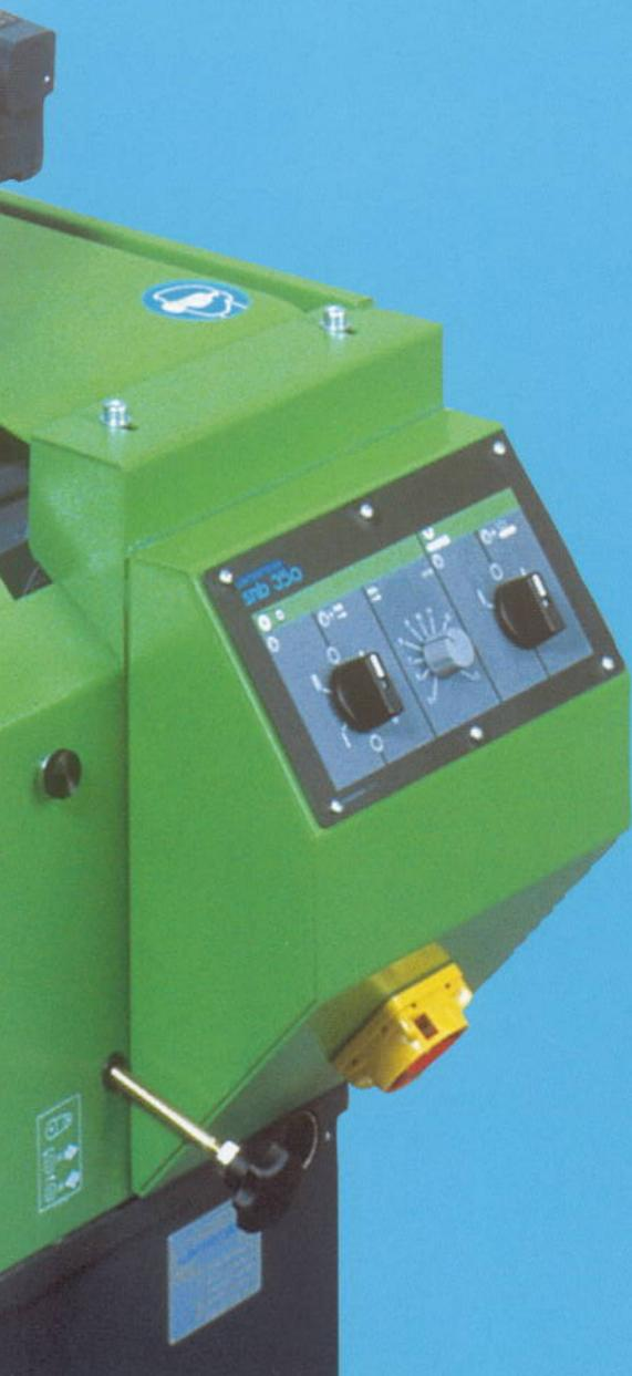
Interrupteur à réglage continu pour la vitesse d'avance
