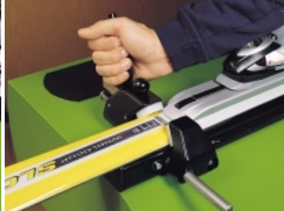
**Passionnant.** Le nouveau système de serrage du speedtronic avec positionnement laser simplifie notablement la manipulation: le positionnement et le serrage s'effectuent en une manipulation! Qu'il s'agisse de skis ou de carvers, speedtronic permet de serrer toutes les largeurs et surfaces de skis et offre le libre accès aux vis de réglage des fixations.
