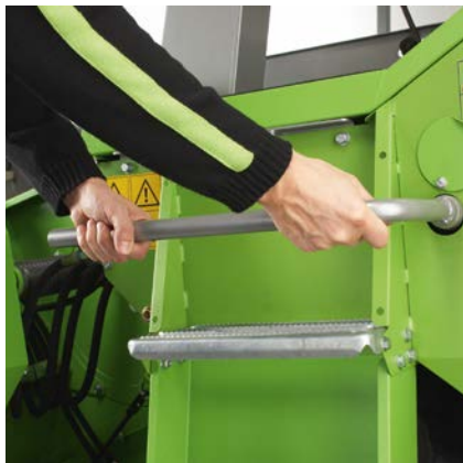
脱粒滚筒逆向旋转设备
