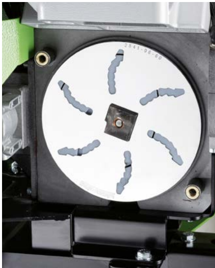
Radialschlitzscheibe und dahinter liegende Spiralschlitzscheibe
