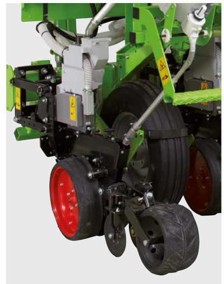
Kompakte Verarbeitung des Elektroantriebs am Saelement
