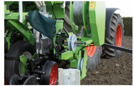
Seilsteuerung mit Seilaufwickler
