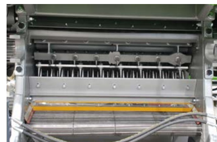
Mecanismo de debulha com pinos
