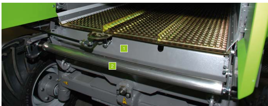
1 Regulagem elétrica da peneira ajustável 2 Sensor de perda de grãos
