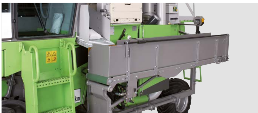
Esteira transportadora de amostras durante o enchimento
