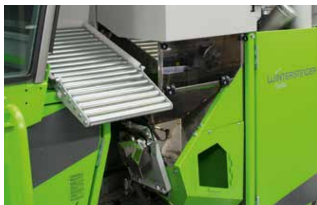
La solution système NIR s'intègre parfaitement dans la séquence sur la moissonneuse-batteuse pour parcelles.
