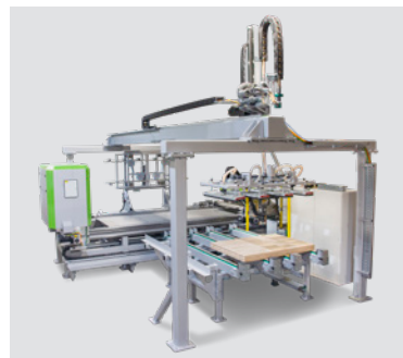
Vollautomatische Ausbesserung von Platten TRC Panel
