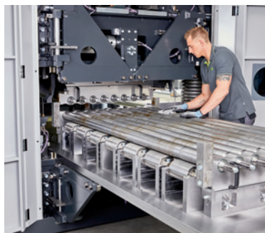
Erweitertes Reinigungssystem für Richtwalzen
